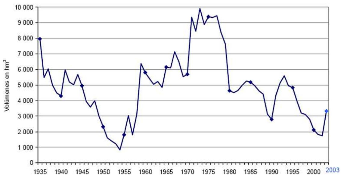
Gráfica I.3. Volúmenes almacenados en el lago de Chapala al 1ro de Octubre de cada año. FUENTE: Gerencia de Aguas Superficiales e Ingeniería de Ríos, SGT, CNA.
